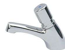
ROBINET RIVER À FERMETURE AUTOMATIQUE • Durée d'écoulement : 20 sec • Durée d'écoulement réglable : 0 - 30 sec • Débit (3 bar) : 7 l/min
