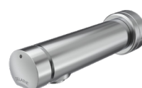
ROBINET DELABIE SOFT À FERMETURE AUTOMATIQUE • Débit : 3 l/min à 3 bar, réglable entre 1,4 et 6 l/min • Durée d'écoulement : 7 secondes
