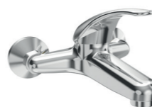
MITIGEUR MONOCOMMANDE • Débit : 22 l/min à 3 bar • Longueur du bec : 155 mm • Clapet anti-retour sur demande
