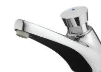
ROBINET PRESTO À FERMETURE AUTOMATIQUE • Débit : 3 l/min à 3 bar, réglable sur 4 positions • Durée d'écoulement : 15 secondes
