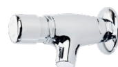
ROBINET RIVER À FERMETURE AUTOMATIQUE • Débit : 7 l/min à 3 bar • Durée d'écoulement : 0 - 30 secondes, réglable au moyen d'une clé Allen
