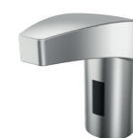
ROBINET ÉLECTRONIQUE • L6B : alimentation par pile • L6T : alimentation sur secteur, transformateur inclus • Débit : 36 l/min à 3 bars • Durée d'écoulement : tant qu'il y a détection, avec un maximum de 120 secondes
