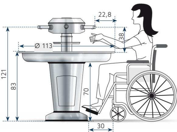
Dans les installations sanitaires, **au moins un lavabo par groupe de lavabos doit être accessible aux fauteuils roulants**, ainsi que divers équipements tels qu'un miroir, un distributeur de savon, un sèche-mains, des crochets pour vêtements, des porte-serviettes. Ces équipements ou parties du mobilier doivent être utilisables par une personne en **position debout et assise**.
